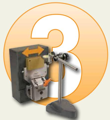
Voreinstellen in drei Achsen mit dem Pendelkopf von System 3R. Dies ist mit einer Genauigkeit von tausendstel Millimetern möglich.
