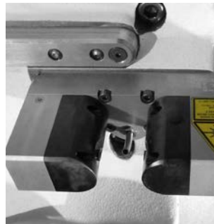
Blasluft auf C-Achse über Lasermesssystem
